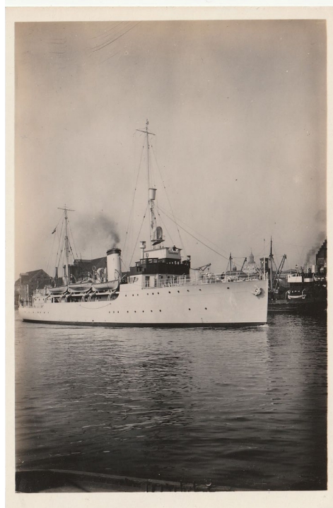
Ill. 3 - Inspektionsskibet HVIDBJØRNEN i Københavns Havn efter stabelfløbningen fra Orlogsværftet 1929. Tonnage 1.050 tons, længde 63 meter. Max fart 15,5 knob. Drivmiddel Olie og med en beholdning på 140 tons. Maskine 1.100 HK. Besætning 61 mand. 2 stk. 87 mm. kanoner og 2 stk. patron kanoner og 1. stk. salutkanon.
