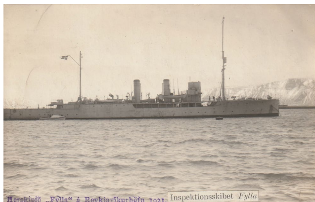
Illustration af FYLLA i Reykjavík 1921. Inspektionsskibet FYLLA Ill. 1 - Inspektionsskibet FYLLA var på 1.300 tons, længde 81,5 meter. Fart 17 knob. Drivmiddel kul, beholdning 300 tons kul. 2.300 HK. Besætning 75 mand. 2 stk. 12 cm. kanon og 2 stk. 57 mm kanon. patronkanoner. 2 stk. 20 mm rekylkanoner. Udgået 1933
