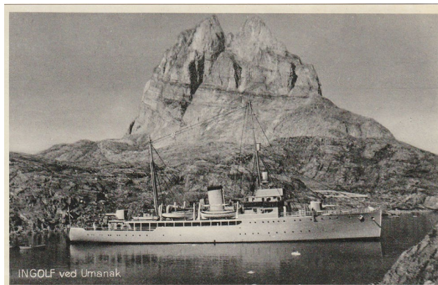
Ill. 5 - Inspektionsskibet INGOLF søsat 1933 fra Orlogsværftet. 1.357 tons, længde 69 meter Max fart 16.2 knob. Drivmiddel olie, beholdning 165 tons olie. 2.935 HK. Besætning 66 mand. 2 stk. 120 mm. og 2 stk. 57 mm. patronkanoner. 2 stk. 20 mm rekyl-kanoner.
